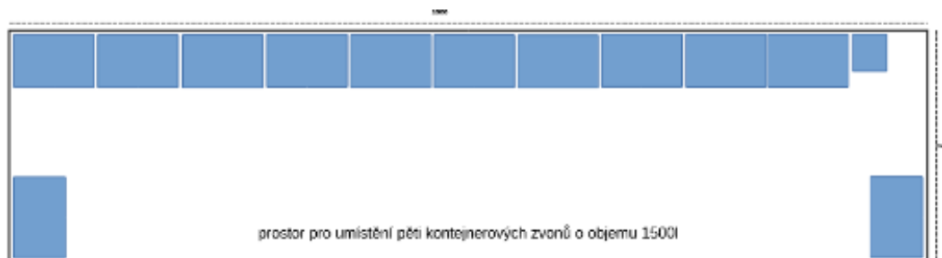
Obrázek 10: Oplocení kontejnerového stání 16x4 m – schematický náčrtek
